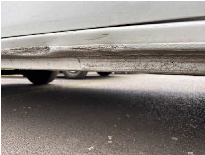
Schweller rechts (Verformung)
