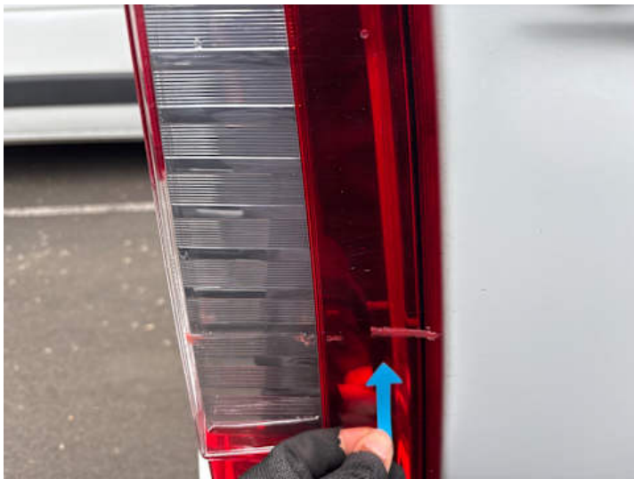
Rücklicht (rechts) (Kratzer)
