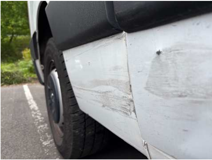
Seitenteil hinten rechts (Verformung)
