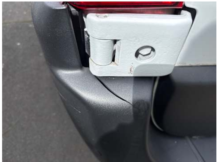
Stoßstange hinten (Riss/Bruch)
