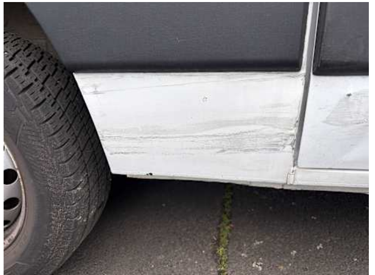
Seitenteil hinten rechts (Verformung)
