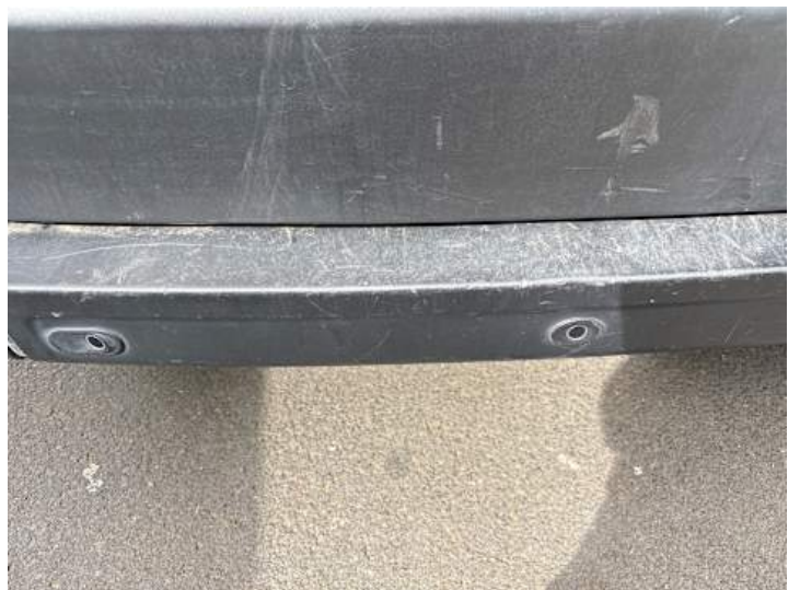
Stoßstange hinten (Kratzer)
