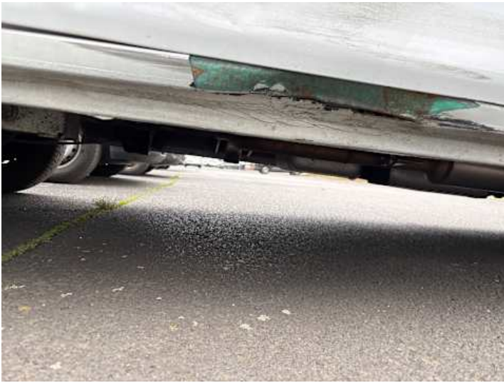
Schweller rechts (Verformung)
