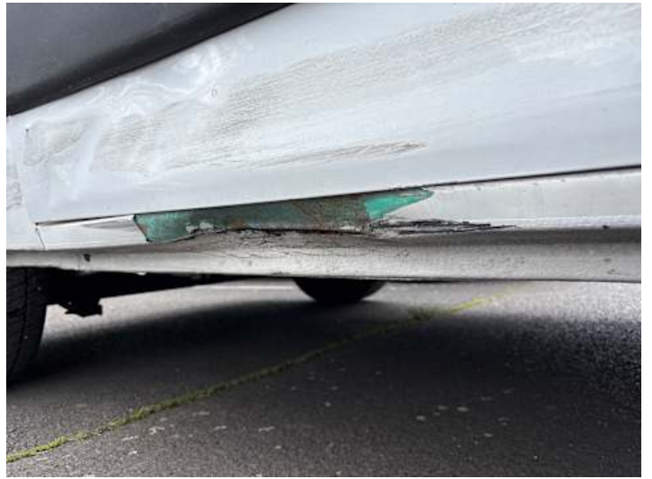
Schweller rechts (Verformung)
