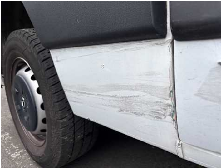
Seitenteil hinten rechts (Kratzer)
