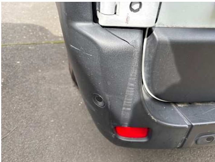
Stoßstange hinten (Kratzer)
