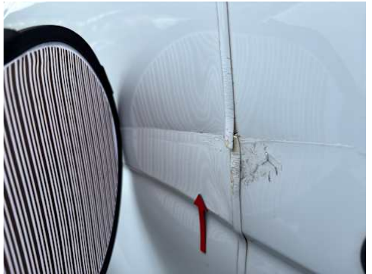
Seitenteil hinten links (Verformung)
