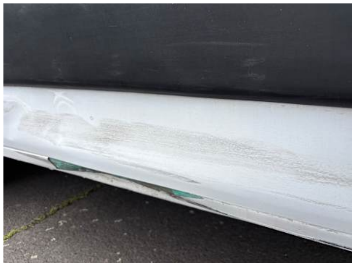
Türe hinten rechts (Kratzer)
