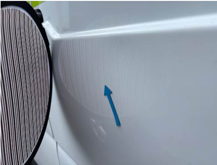
Türe hinten rechts (Verformung)
