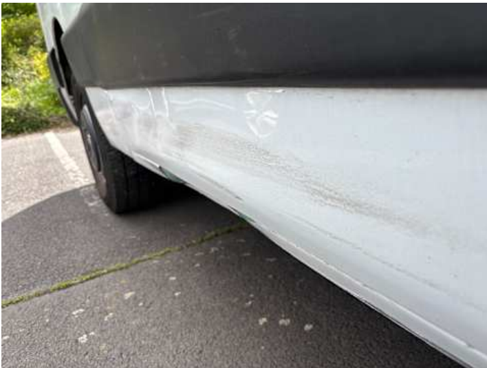
Türe hinten rechts (Verformung)
