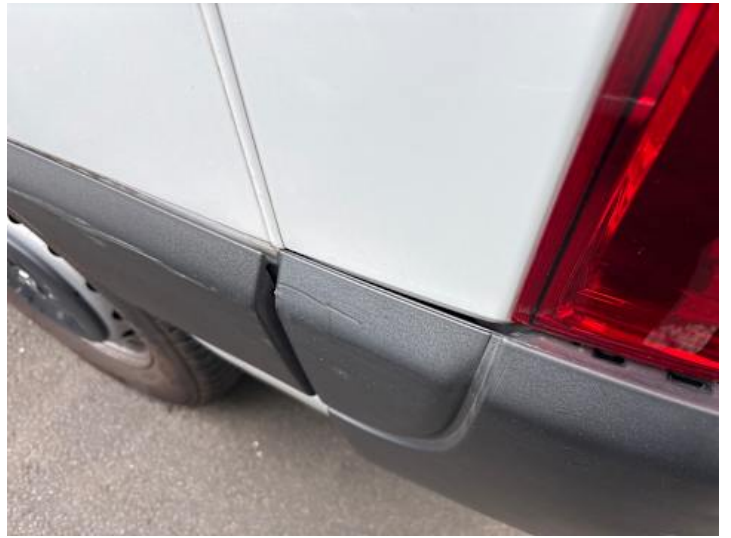
Seitenteil hinten links (Riss/Bruch)
